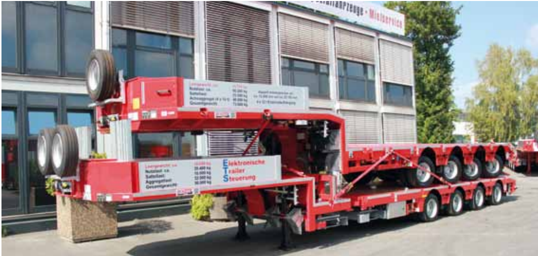
Auflieger oben: 4-Achs-Semitielflader, doppelt teleskopierbar mit Tridex/DLS Einzelaufhängung Auflieger unten: 4-Achs-Semitielflader, teleskopierbar mit ETS (Elektronische Trailer Steuerung)
