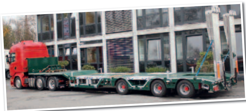
► Zum Scania passend: Eine Kombinationsmöglichkeit stellt der Mix 15 mit doppelter, hydraulischer Aluminiumrampe und 9° Auffahrwinkel dar.
