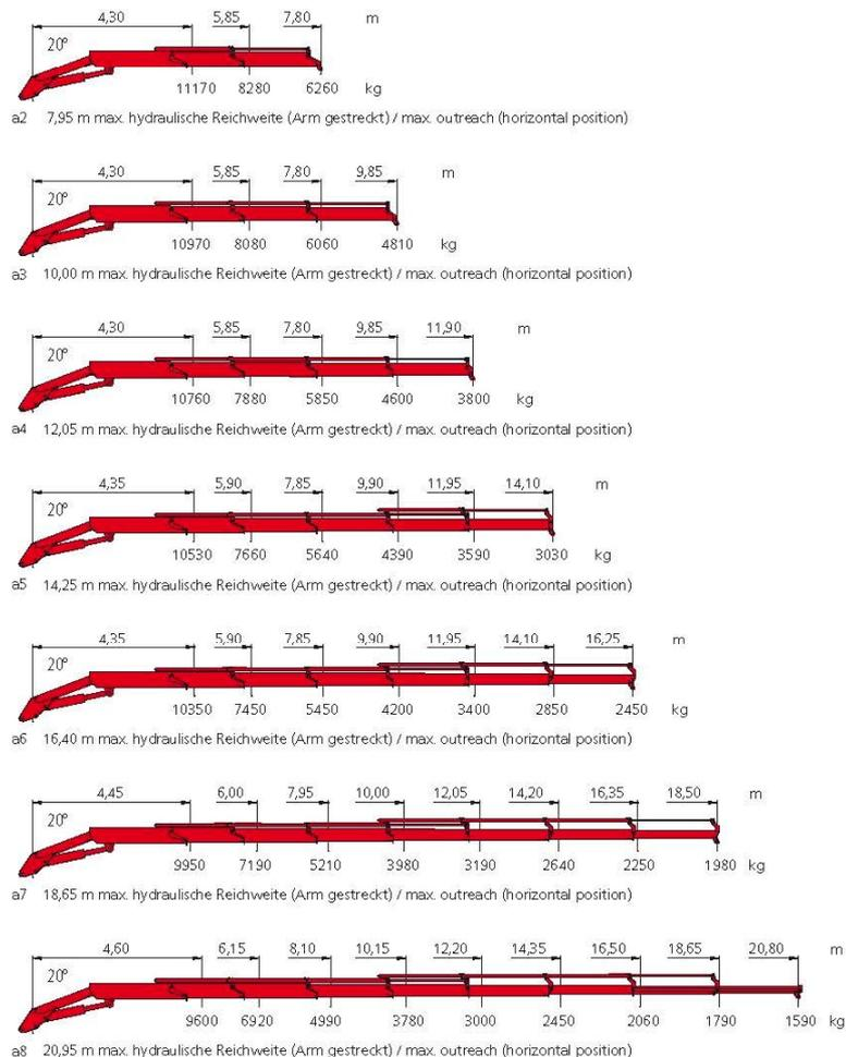
Hubarmstellung +20°. Alle Traglastangaben bis zur maximalen hydr. Reichweite gelten ohne Handstücke. Sämtliche Angaben gewissenhaft, jedoch unverbindlich. Konstruktionsänderungen vorbehalten.
